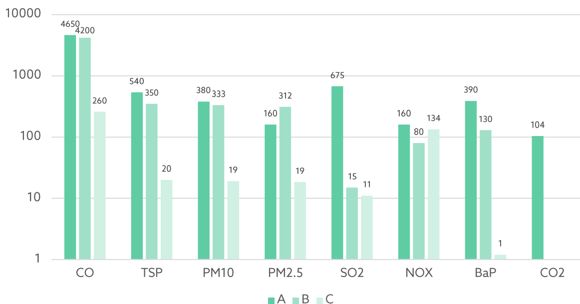
Rysunek 10 Emisja zanieczyszczeń ze spalania: A) węgla, B) drewna w tradycyjnych kotłach, C) pelletów drzewnych w kotłach spełniających wymagania Rozporządzenie KE (UE) 2015/1189, skala logarytmiczna
