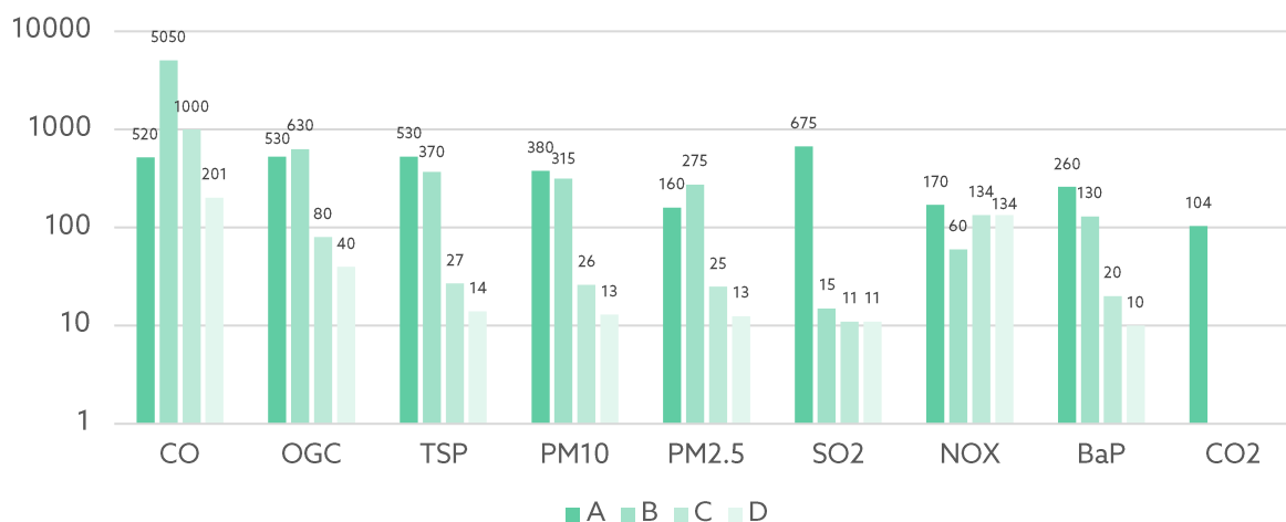
Rysunek 9 Emisja zanieczyszczeń ze spalania: A) węgla i B) drewna w tradycyjnym ogrzewaczu pomieszczeń; C) drewna kawałkowego w ogrzewaczu wg Rozporządzenie KE (UE) 2015/1185; D) pelletów drzewnych w piecu wg Rozporządzenie KE (UE) 2015/1185, skala logarytmiczna
